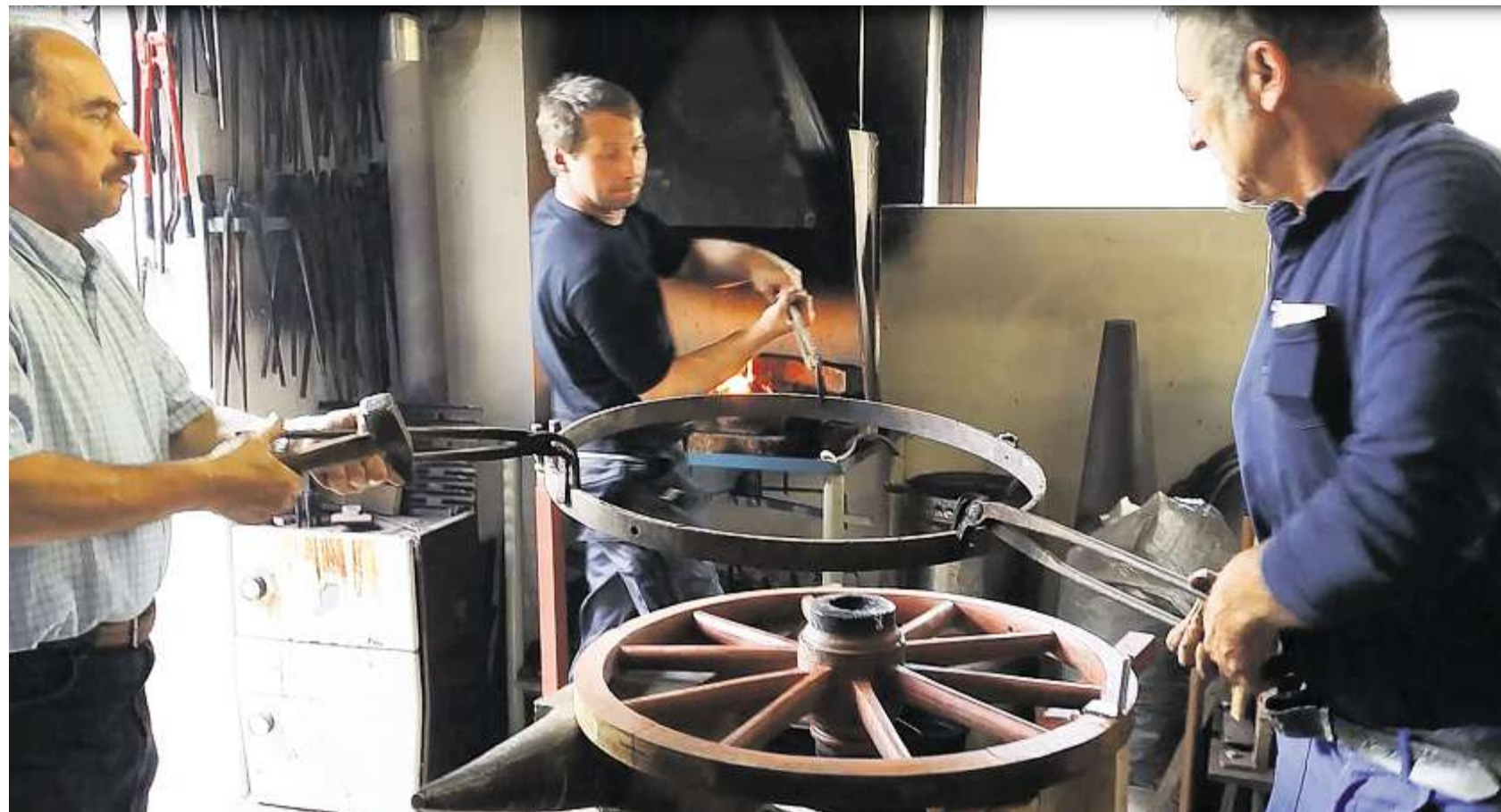
Der auf etwa 400 Grad abgekühlte Eisenreifen wird wieder auf das Rad der Pentinger Löschmaschine aufgeschumpft.
